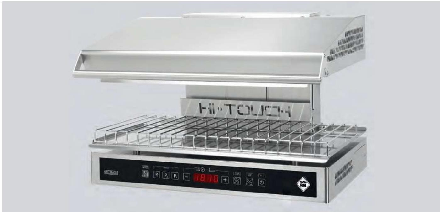
Salamandry jsou otevřená zařízení, jejichž topný zdroj generuje teplo vyzařující z vrchní části směrem dolů. Díky speciálním topným prvkům a výškové nastavitelné horní části lze nastavít topnou část bliže nebo dále od pokrmu z důvodu rozdílného způsobu přípravy. Systém je ideální pro úpravy servírovaných porcí, speciálně gratinovaných a nahřívaných.
